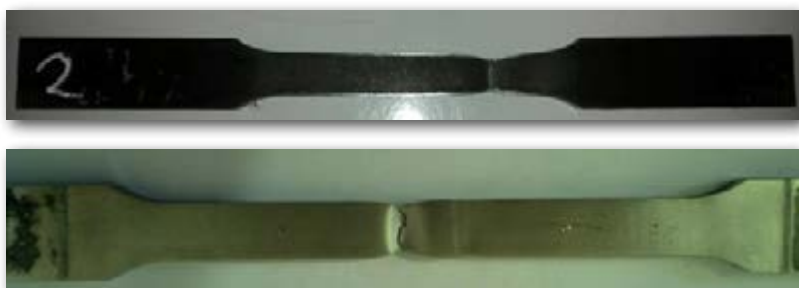
Figura 2. Probetas de tracción ensayadas. a) Material base, b) Junta soldada
