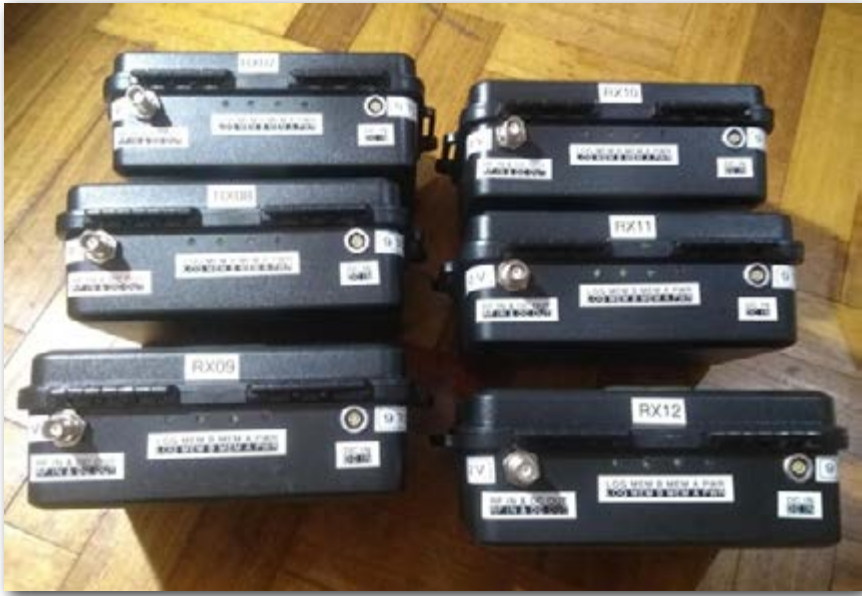
Figura 2. Receptores DIY en sus caja estancas, listos para ser empleados. El panel de luces LED, con diversos modos de intermitencia o indicación continua, permite al operador controlar rápidamente el estado del equipamiento durante su instalación (fuente de alimentación, adquisición de señal GNSS, estado de las memorias disponibles, etc.).
