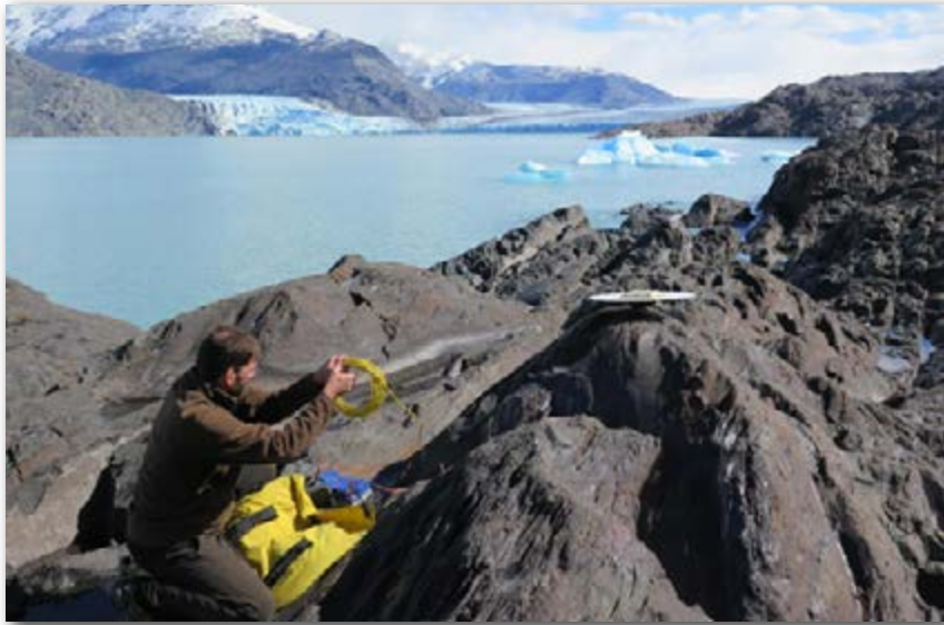
Figura 4. Instalación de receptor GNSS en la zona de los glaciares, provincia de Santa Cruz, durante una campaña de verano. El equipamiento, alimentado con paneles solares, recolectará datos durante todo un año.
